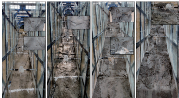
(a) 浸润侵蚀阶段 (b) 表层变形阶段 (c) 破坏加深阶段 (d) 整体失稳阶段
