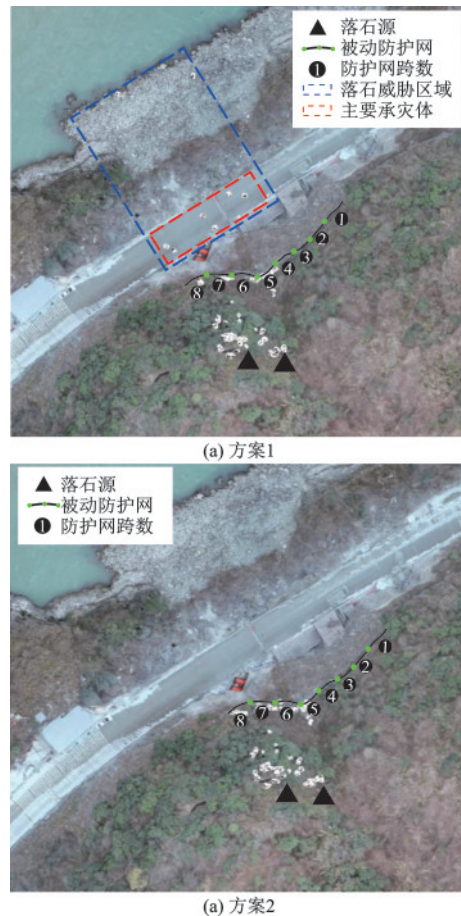
图10 修复加固后的落石威胁区域
