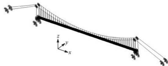
图8 三维杆系有限元模型
