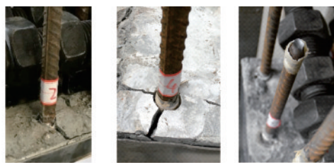
图7 试件典型破坏形式
