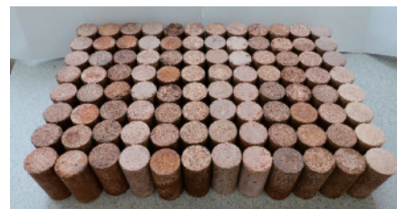
图2 养护中的试样
