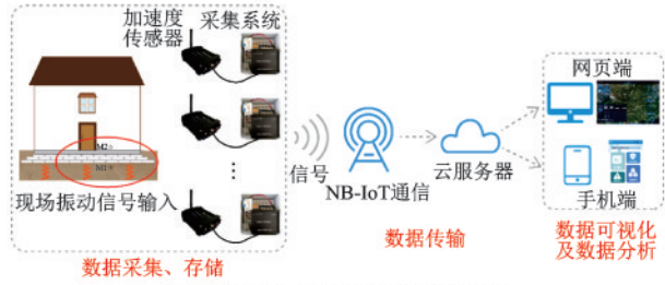
(b) 加速度采集与监测系统工作示意图
