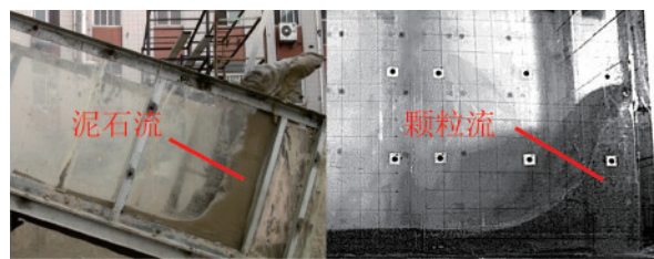
图1 室内实验中观察到的泥石流及颗粒流的冲起爬高现象
