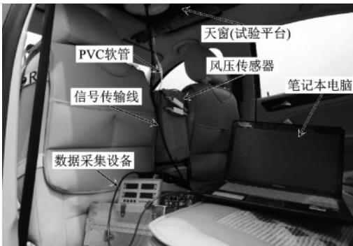
图 3 车内的信号采集测试系统 Fig.3 Arrangement of interior collecting instrument
