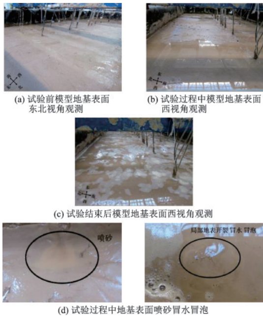
图 25 工况 1 试验过程中模型地基土的宏观现象
