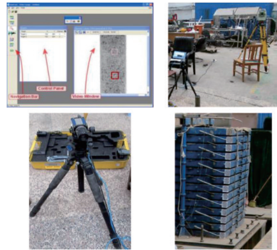
图 20 非接触式位移监测系统
