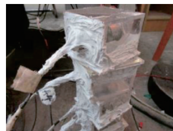
图 22 AFT8型电压力式加速度传感器及防水处理
