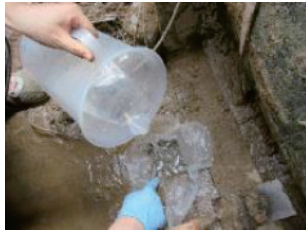
图8 灌水法测试地基土密度
