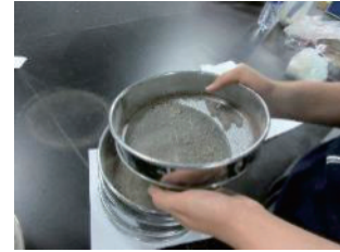
图3 砂土颗粒筛分试验
