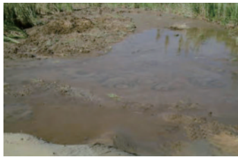
图14 固玛镇液化喷水冒砂 [30]
