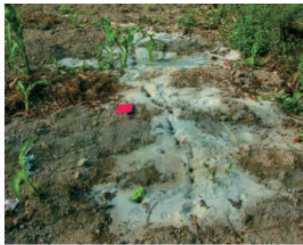
(b) 展动堤附近细砂沿地裂缝喷出地表
