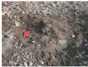
(a) 地震引起的扎曲河漫滩砂土液化
