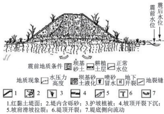
图10 盈江大堤土壤液化灾害效应示意图 [27]
