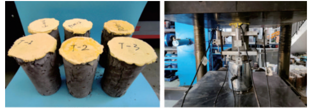
(a) 圆柱体混凝土试块 (b) 弹性模量实验装置
