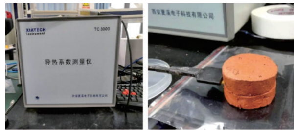
(a) 导热系数测量仪
