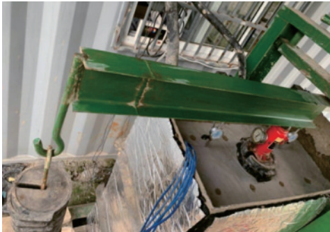
图 4 太阳能热排水固结模型试验
