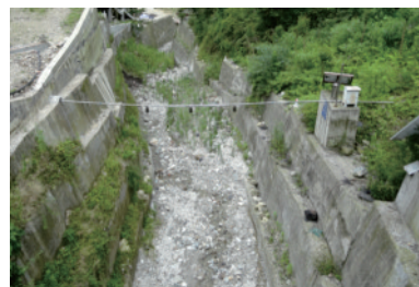
图 17 锅圈岩沟泥位监测装置示意
