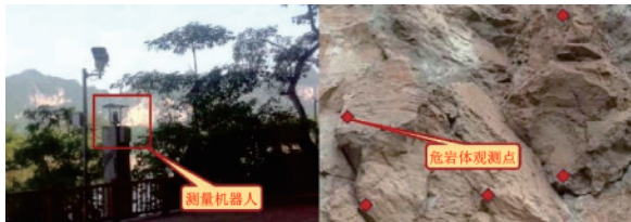
图3 测量机器人(左)监测危岩体(右)
