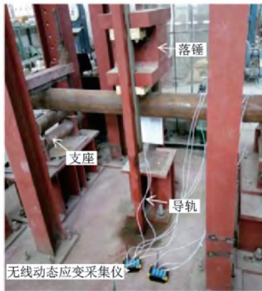
图3 落锤试验机装置 [41]
