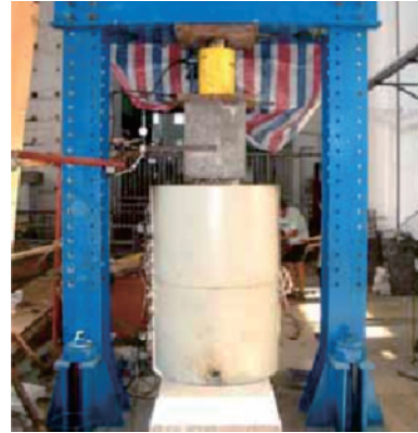
图4 火灾-抗震耦合试验装置 [47]
