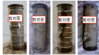
图6 冻融-腐蚀下钢管混凝土柱轴压破坏形态 [57]
