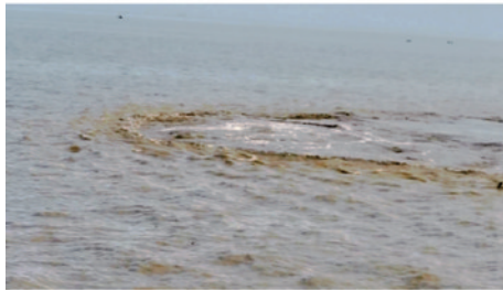
(b) CZHY18号钻孔浅层气喷发20天之后海面情况
