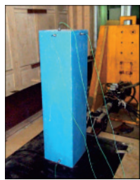
图7 刚性体摇摆试验 [59]
