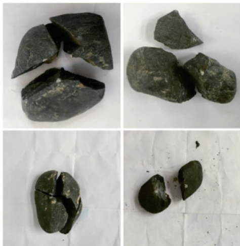
图9 点荷载试样破坏特征
