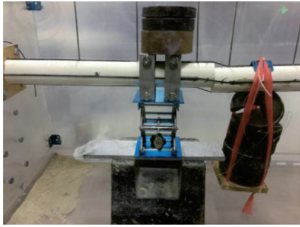
图9 悬臂梁试验过程
