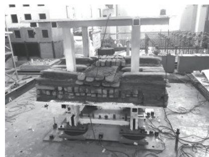
图 29 组合式大位移摩擦摆底层隔震结构实验
