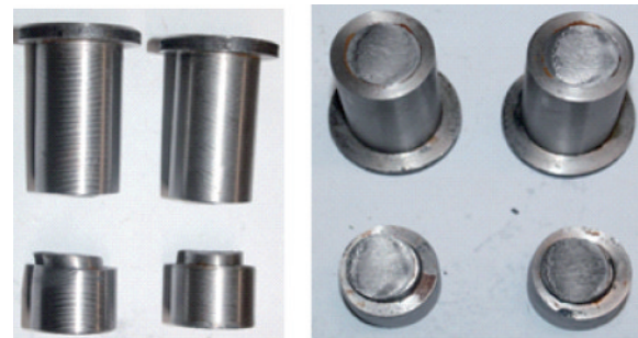
图11 剪力销破坏断面
