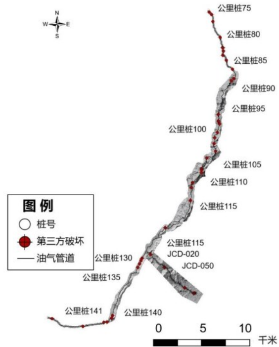
图6 第三方扰动破坏点解译分布图
