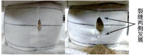
图5 土工袋破坏示意图
