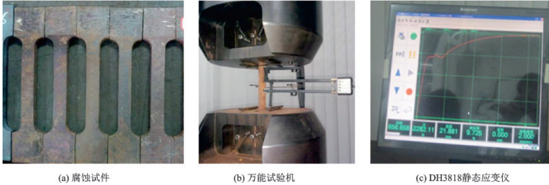
图 1 腐蚀试件的单向拉伸试验
