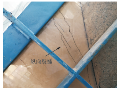
图7 加载0.6g X向边坡侧面裂缝
