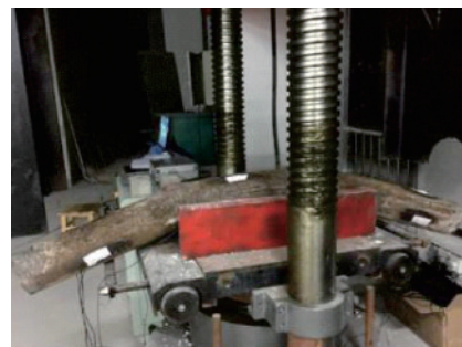
图8 钢管混凝土微型桩破坏
