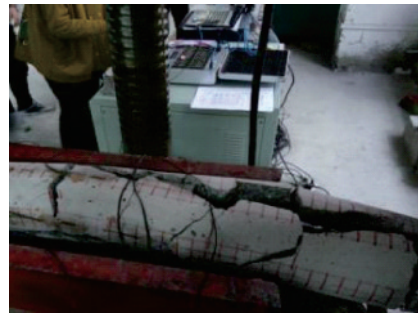
图7 钢筋混凝土微型桩破坏
