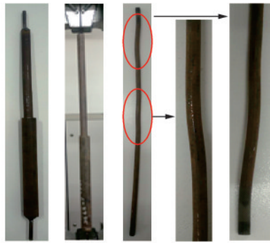
图4 约束屈曲纵筋试验前后实拍
