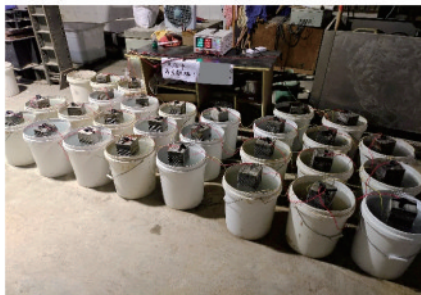
图1 电化学除氯装置
